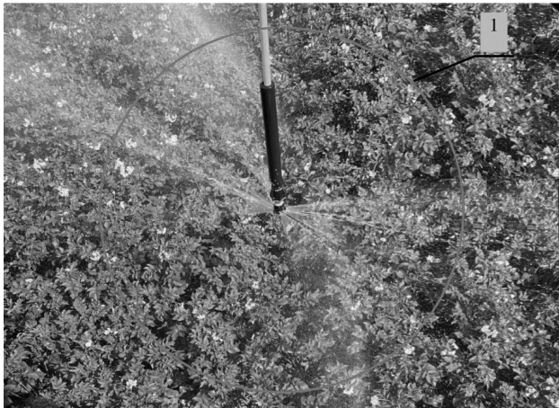
Рисунок 2 – Граница зоны смачивания дождевателя фирмы Nelson D3000 (тип 38) в плоскости распыла на уровне 1,9 м от поверхности земли, радиусом 1,4 м
