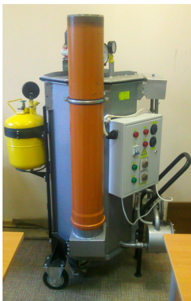
Рисунок 3 – Конструкция биогазовой установки для утилизации отходов животноводства
