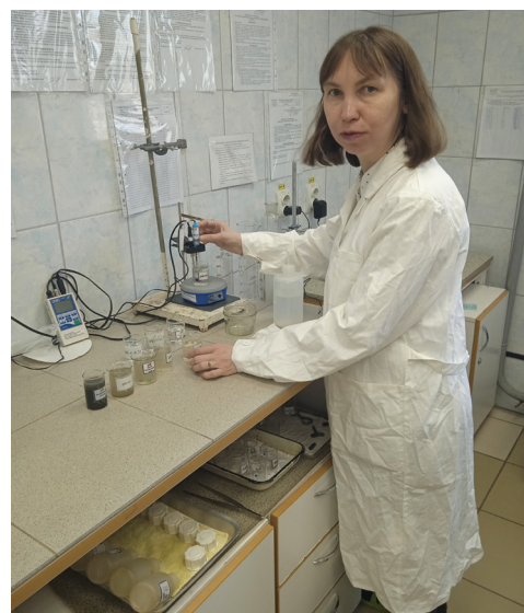
Рисунок 4 – Проведение анализа по определению активной реакции среды pH
