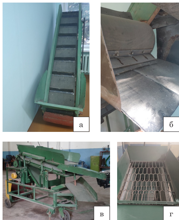
Рисунок 5 – Подающий транспортер и грохотное калибрующее устройство: а – подающий транспортер; б – место падения клубней с барабана на скатной лоток; в – общий вид грохотного калибрующего устройства с лотком мелкой фракции под нижним решетом; г – эластичная рабочая поверхность решета
