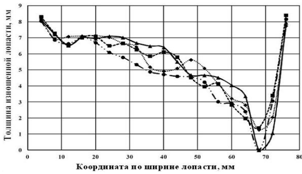
Рисунок 7 – Толщина изношенной поверхности по внешнему контуру четырех лопастей колеса
