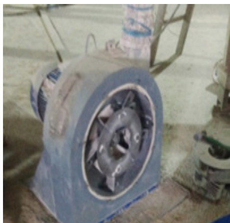
Рисунок 1 – Молотковая дробилка зерна ДКР-4 с изношенным барабаном
