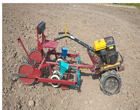
Рисунок 9 – Малогабаритная сеялка для семян моркови: а – на почвенном канале, б – на полевых испытаниях
