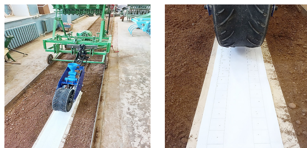
Рисунок 18 – Лабораторные исследования экспериментального высевочного аппарата на почвенном канале
