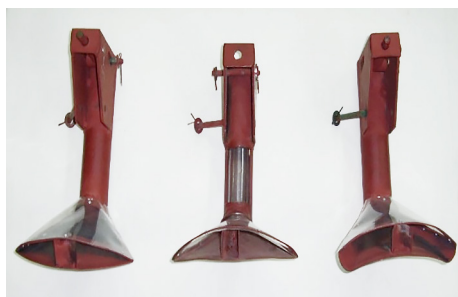
Рисунок 12 – Распределители семян с различной кривизной распределяющей пластины
