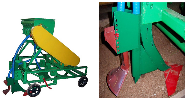
Рисунок 11 – Универсальная установка с экспериментальным сошником для стерневой сеялки зерновых культур
