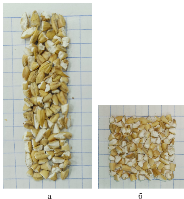
Рисунок 8 – Пример распределения частиц измельченного зерна средним диаметром: а – 2,75 мм; б – 2,25 мм
