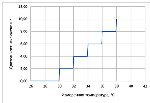
Рисунок 6 – График зависимости длительности фазы включения в периоде от измеренной температуры
