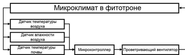
Рисунок 3 – Обобщенная блок-схема автоматической системы вентиляции
