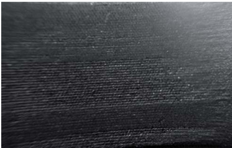
Рисунок 3 – Топография поверхности модифицированного баббитового покрытия (x 10)
