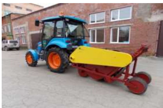
Рис. 3 - Однорядный копатель-сборщик КСК-1 с загрузкой клубней в контейнер или сетчатые мешки в агрегате с трактором ТК-30
