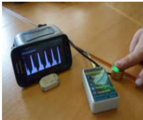
Общий вид разработанного автономного фотоплетизмографа с датчиком, работающим в зеленой области спектра, и регистрацией сигнала на смартфон с помощью Bluetooth
