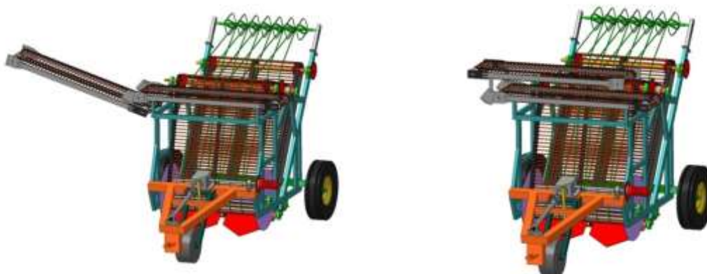
Рис. 4 – 3-D модель двухрядного копателя-сборщика
