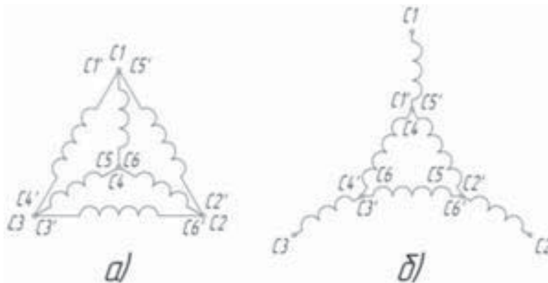
Рисунок 1 – Схемы соединения частей совмещенных обмоток: а) параллельное соединение; б) последовательное соединение
