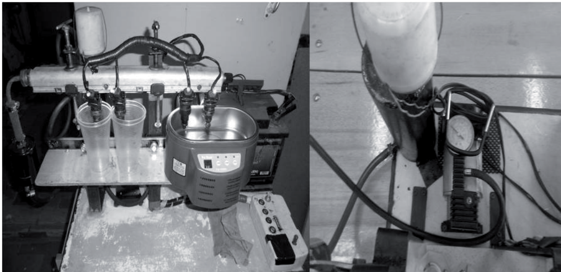
Рисунок 2 – Общий вид установки для проверки и очистки форсунок впрыска
