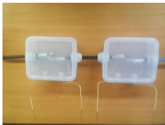
Рисунок 2 – Общий вид устройства по испытанию неподвижных неразмыкаемых контактных соединений
