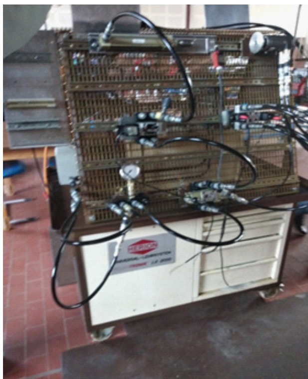
Рисунок 6 – Испытательный гидравлический стенд
