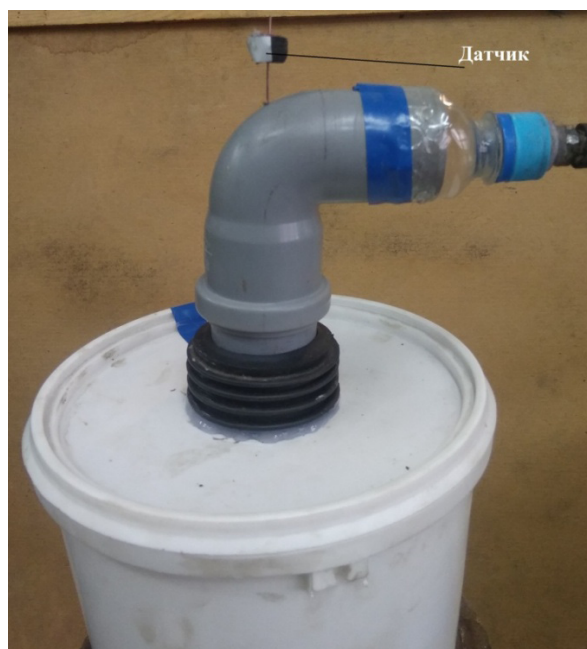
Рисунок 2 – Общий вид пылеуловителя с датчиком оборотов
