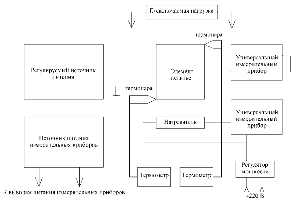
Рисунок 2 – Лабораторная установка. Схема функциональная.
