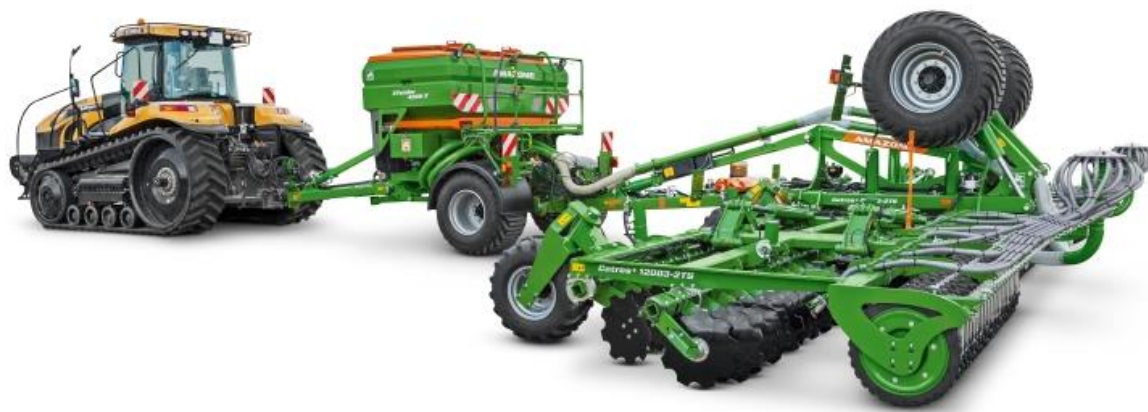
Рисунок 2 – Почвообрабатывающе-удобрительный агрегат: X-TenderT + Catros
