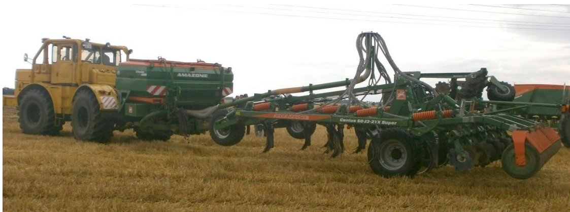
Рисунок 1 – Почвообрабатывающе-удобрительный комбинированный агрегат компании «AMAZONEN-Werke», состоящий из бункера X-Tender-4,2 и культиватора мульчировщика-глубокорыхлителя Cenius
